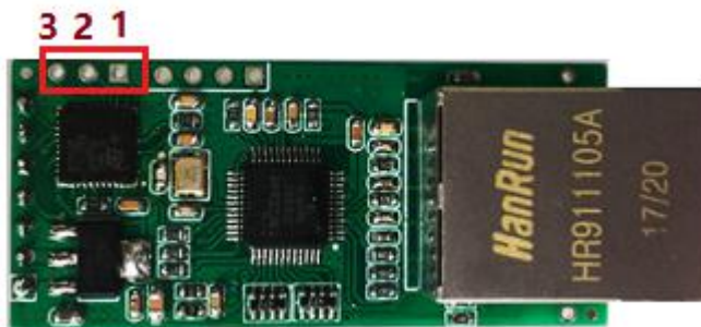
图 8. 预留引脚图示
